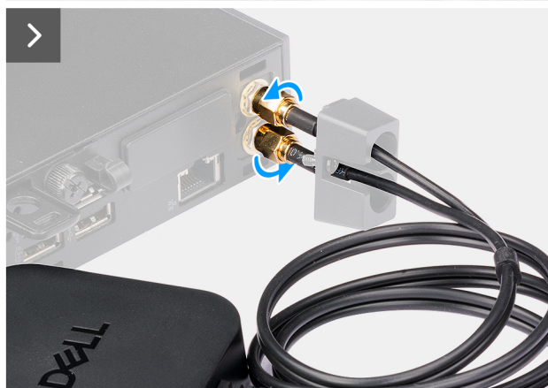
Obrázok 34. Demontáž externej antény Puck
