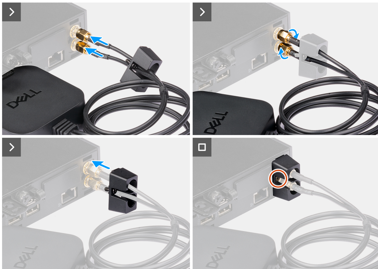
Obrázok 35. Montáž externej antény Puck
