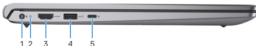
Obrázok 2. Pohľad zľava – počítače dodávané s portom USB Type-C s funkciou DisplayPort a funkciou napájania
