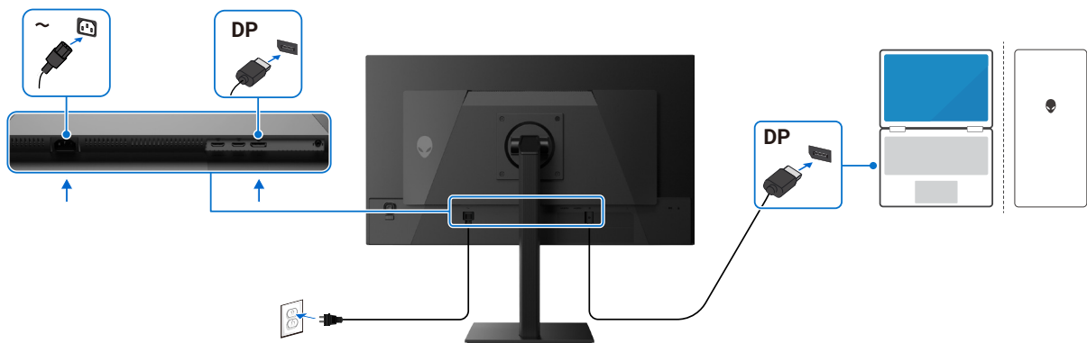
Obrázok 20. Zapojenie kábla DisplayPort (DP do DP)
