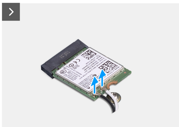
Obrázok 30. Demontáž karty bezdrôtovej komunikácie
