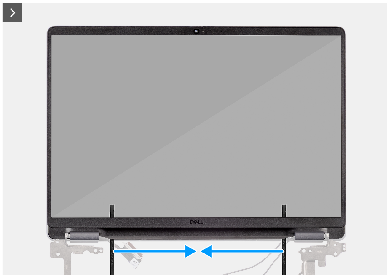
Obrázok 78. Demontáž rámu obrazovky
