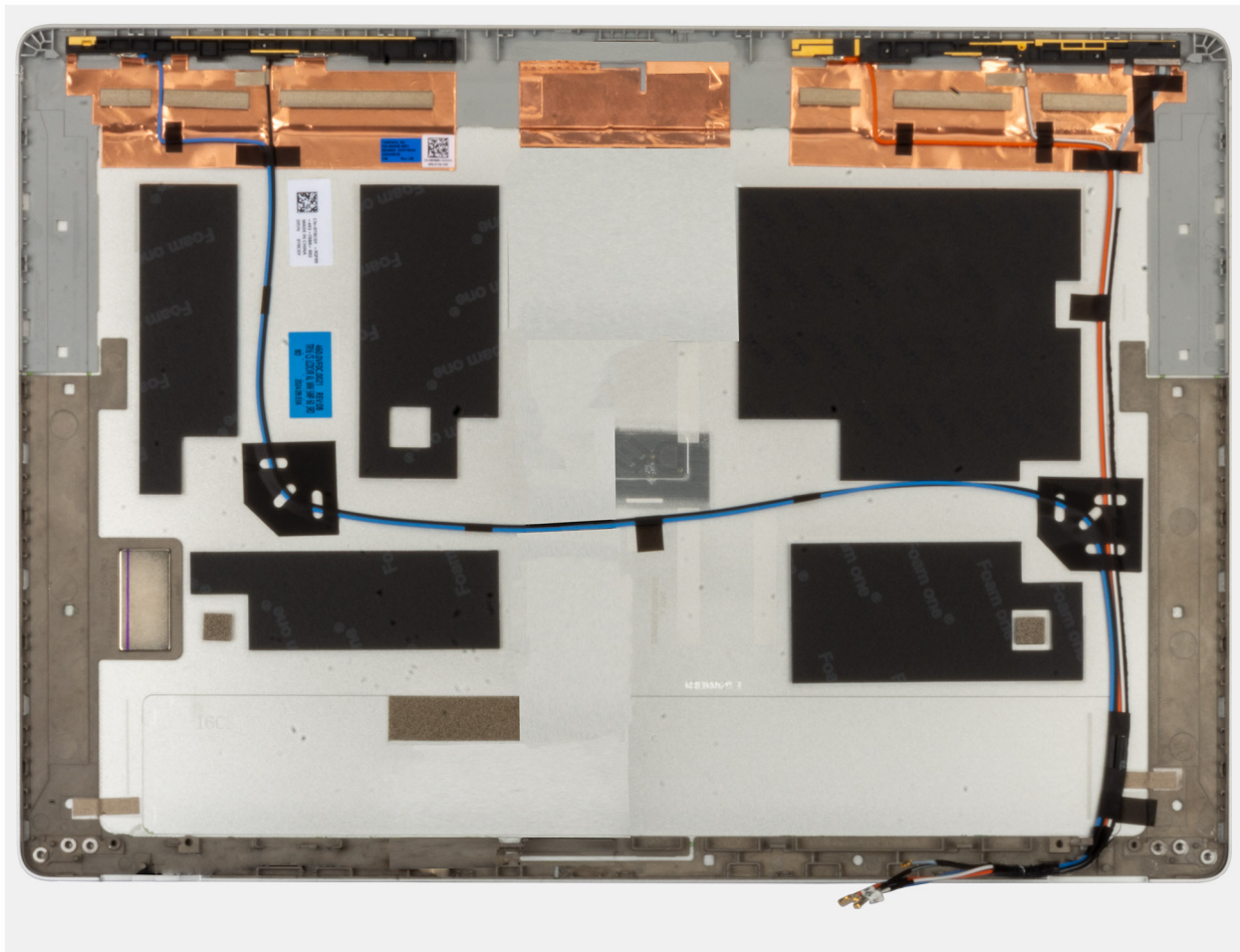
Obrázok 40. Demontáž zadného krytu obrazovky
