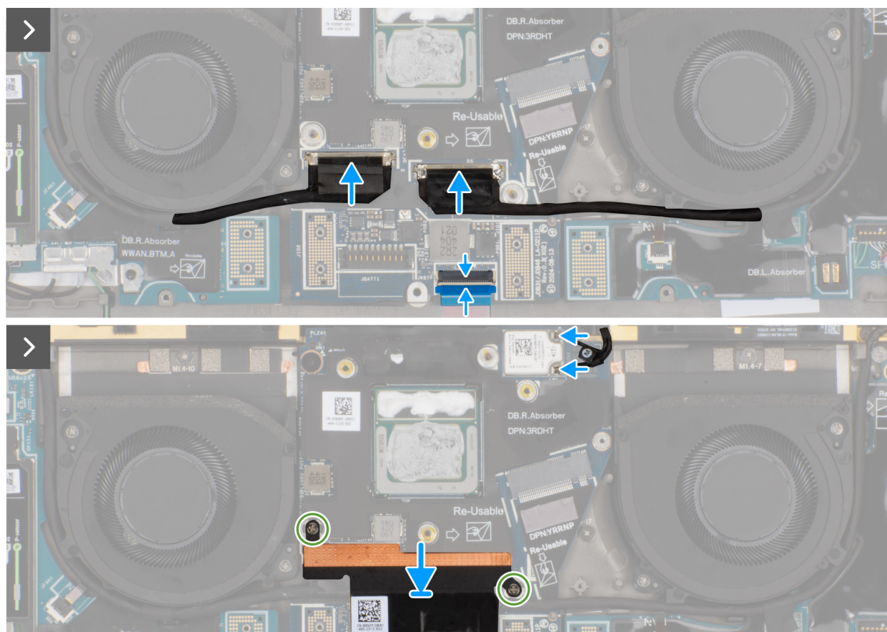
Obrázok 68. Montáž systémovej dosky
