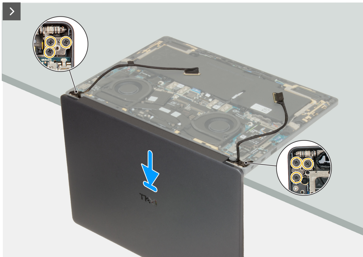
Obrázok 59. Montáž zostavy obrazovky
