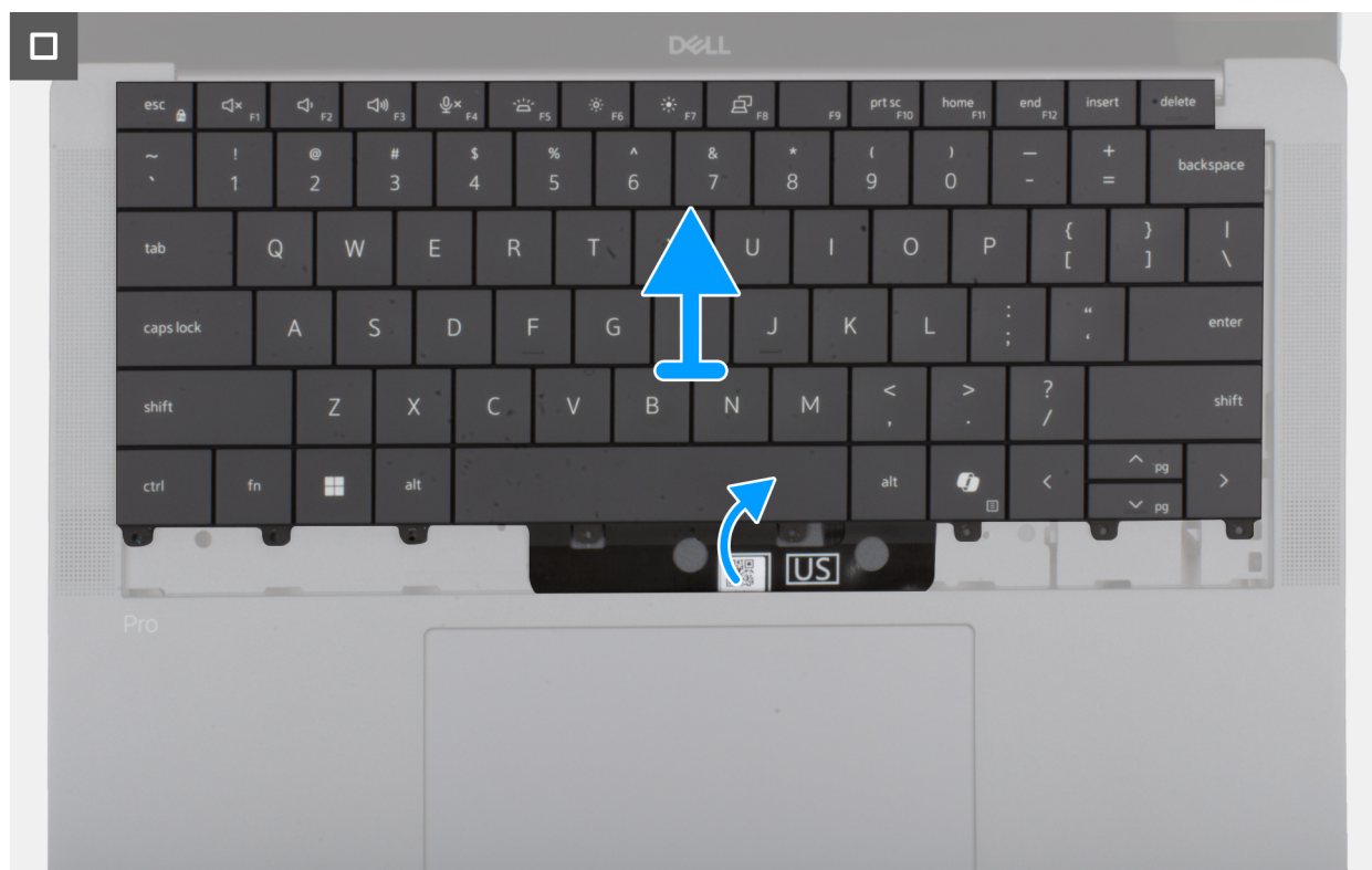
Obrázok 72. Demontáž zostavy klávesnice
