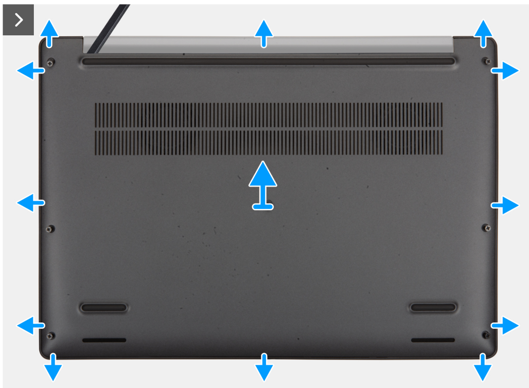
Obrázok 15. Demontáž spodného krytu
