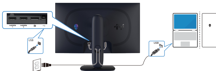
Figure 30. Zapojenie kábla USB Type-B (Type-B do Type-A)
