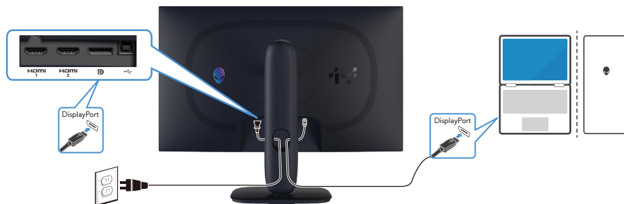
Figure 28. Zapojenie kábla DisplayPort (DP do DP)
