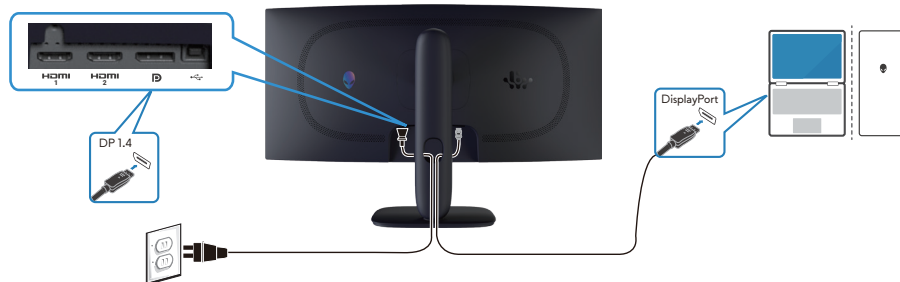
Obrázok 22. Zapojenie kábla DisplayPort (DP do DP)
