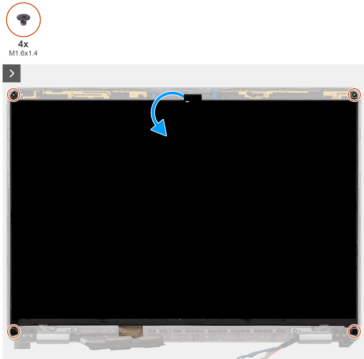
Obrázok 72. Demontáž zobrazovacieho panela
