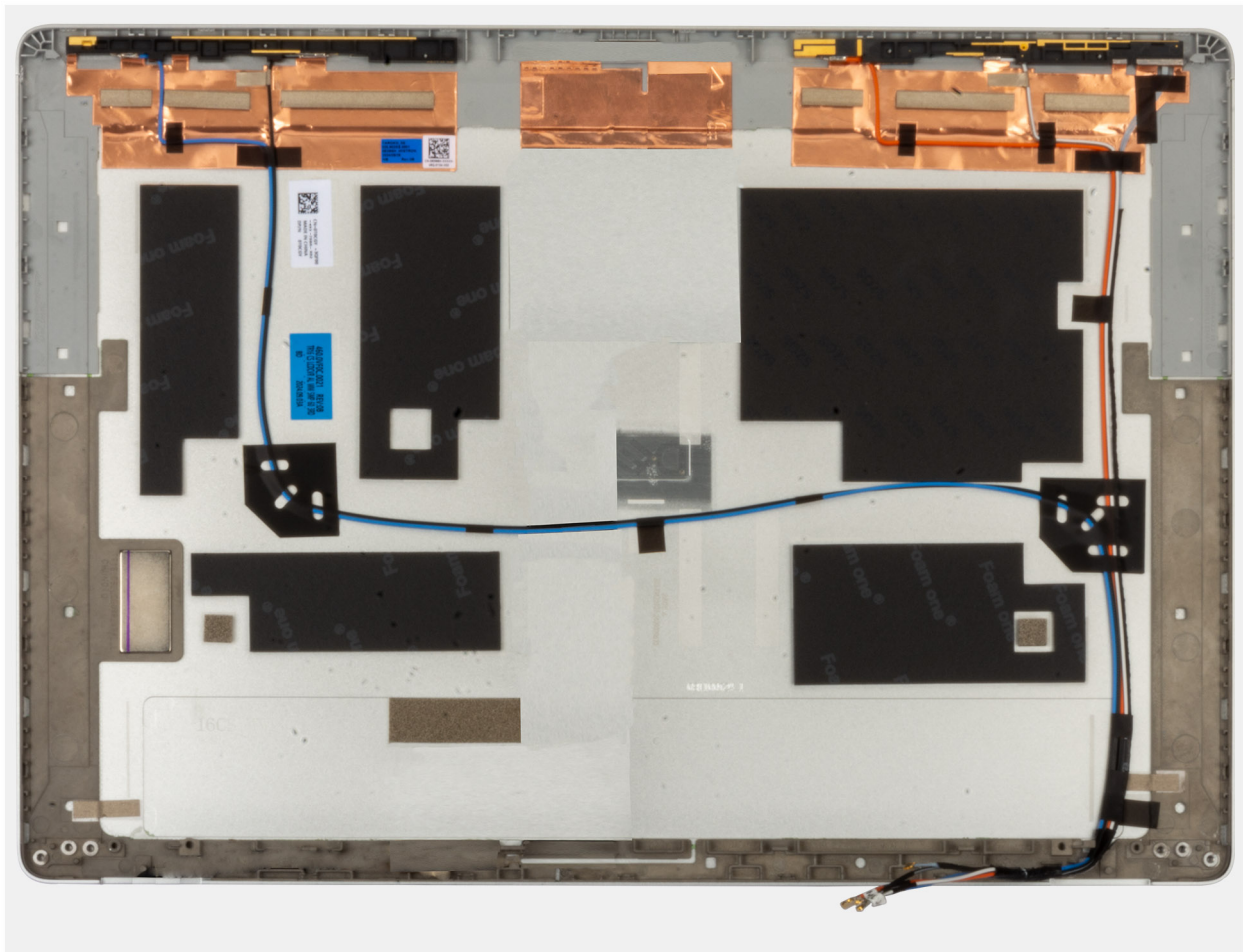
Obrázok 77. Demontáž zadného krytu obrazovky
