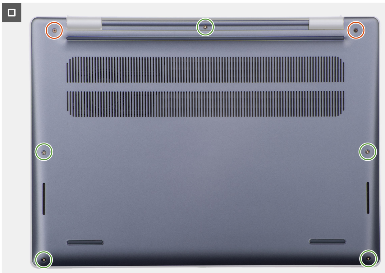
Obrázok 19. Montáž spodného krytu
