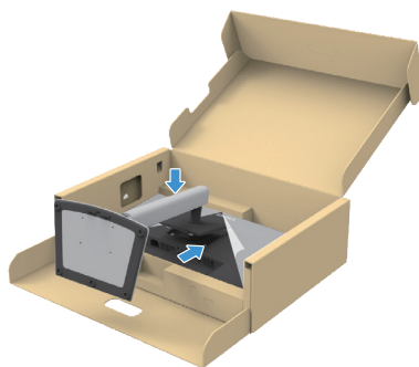
Obrázok 16. Pripojenie zostavy stojana k displeju
