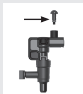
Napeňovacia dýza s vybratou rúrkou na nasávanie vzduchu
