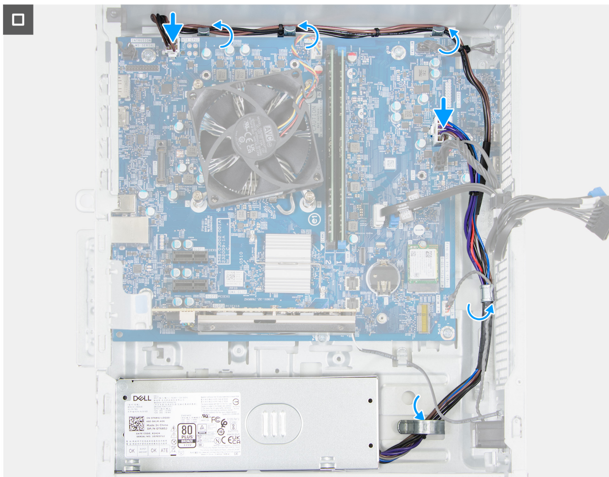
Obrázok 66. Montáž napájacieho zdroja
