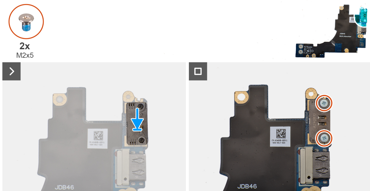
Obrázok 54. Installing the left USB Type-C module
