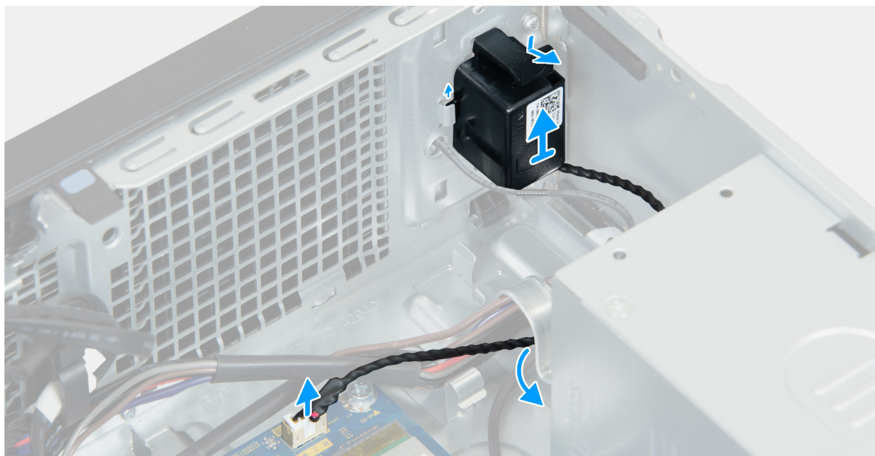
Obrázok 18. Demontáž interného reproduktora
