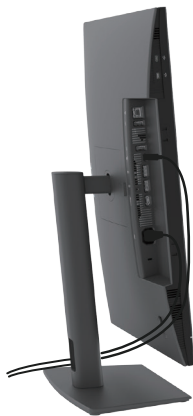
Obrázok 52. Pripojte káble v najvyššej, najviac natočenej polohe.
