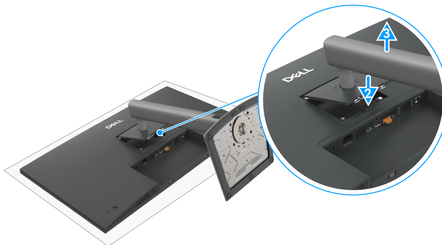
Obrázok 55. Odmontovanie stojana z monitora
