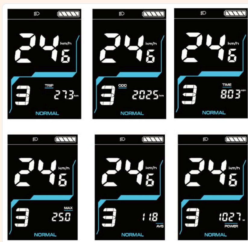
Cyklus zobrazovaných údajov: Trip, ODO, doba jazdy, max. rýchlosť, priemerná rýchlosť, výkon motora
